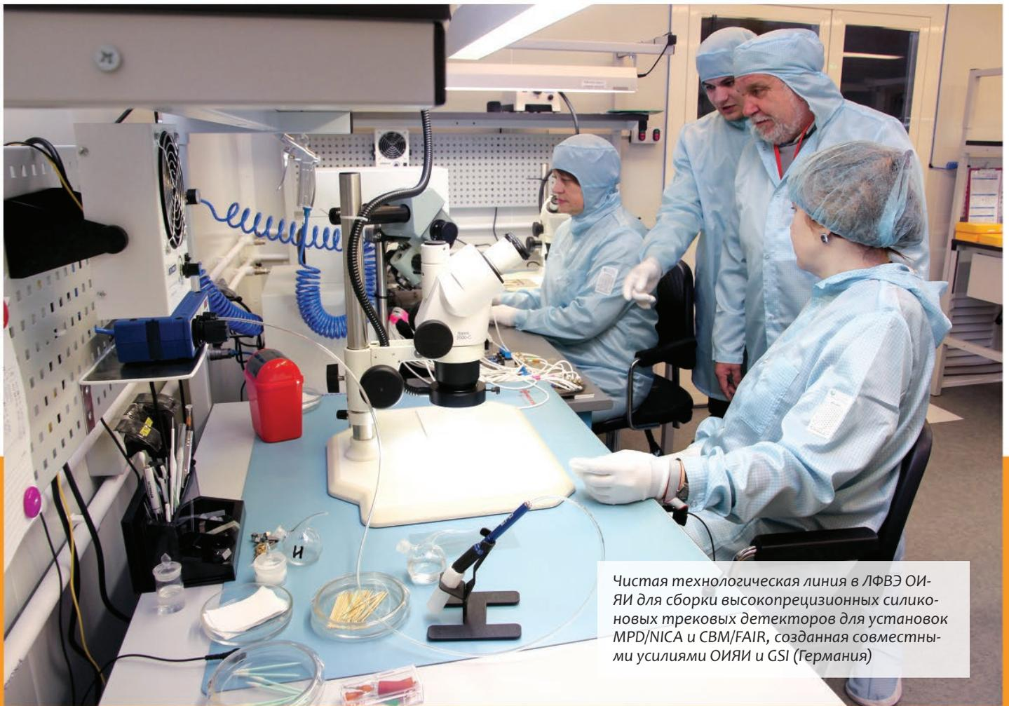
Чистая технологическая линия в ЛФВЭ ОИ-ЯИ для сборки высокоточных кремниевых трековых детекторов для установок MPD/NICA и CBM/FAIR, созданная совместными усилиями ОИЯИ и GSI (Германия)
